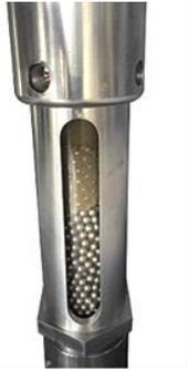
用 20~40 目的砂床模拟渗透率约为 10 达西的地层，图为某种钻井液的侵入程度模拟
